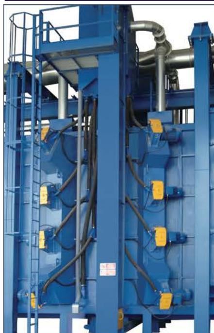
TUNNEL DI GRANIGLIATURA CON TRASPORTATORE AEREO
