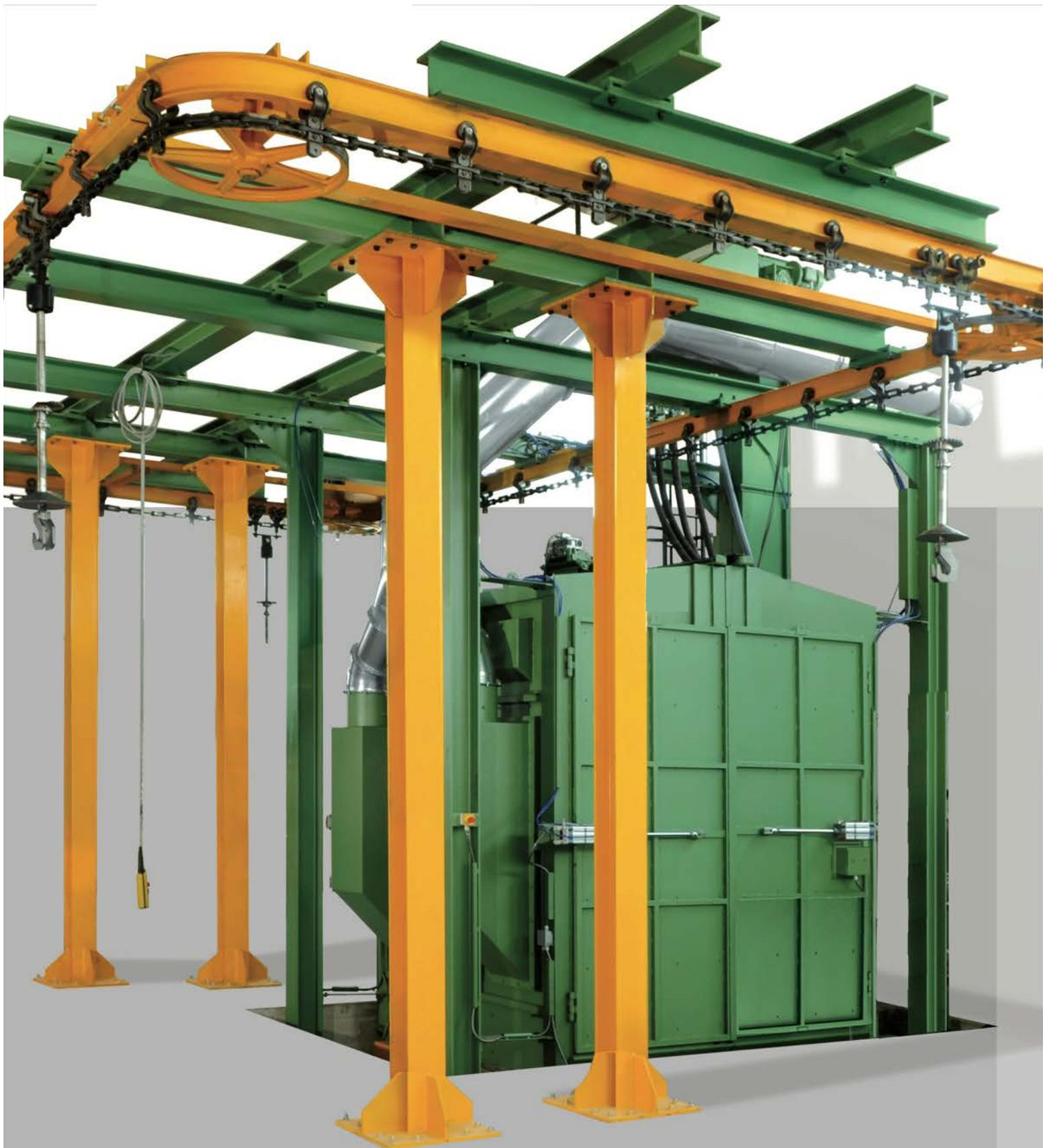
Le **macchine granigliatrici a carosello** sono state progettate al fine di garantire elevate produzioni e possono facilmente essere messe in linea con impianti di produzione e verniciatura.
